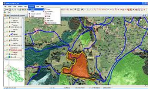
Editando una capa vectorial de polígonos con el sistema de información geográfica de código libre gvSIG .
